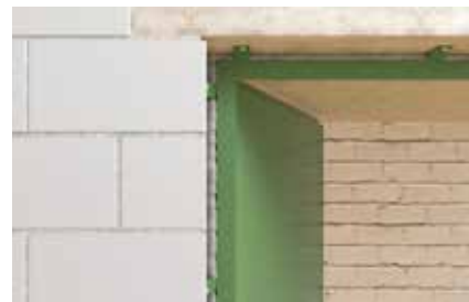
Vyplňovanie dutín v izolácii
