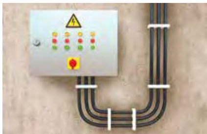
Upevnenie káblových zväzkov
