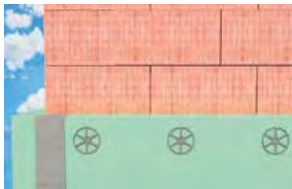
Lepenie izolačných dosiek z polystyrénu
